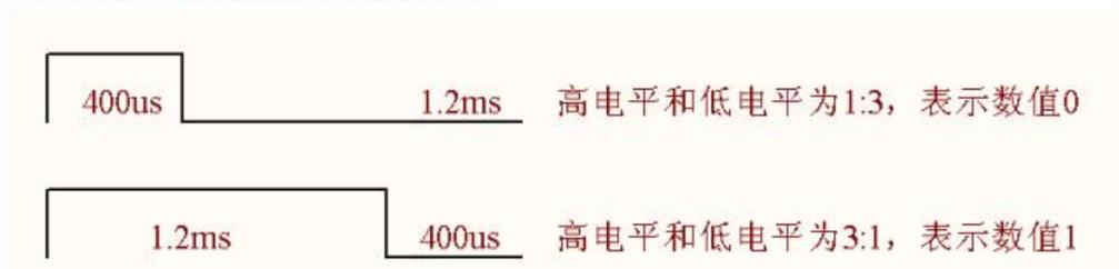
注: BUSY 为语音芯片输出忙信号输出,数据成功发送和等待 250us, BUSY 输出将作出响应。BUSY 输出 25ms 后,语音输出将做出响应。DATA 拉低时间范围: 4~6ms; 一线串口高低电平 1:3 时序范围: 350us: 1.05ms~1.2ms: 3.6ms, 推荐使用 1:3 比例为 400us:1.2ms。
